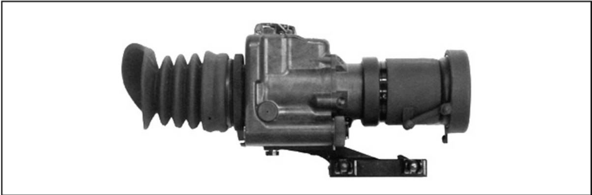
Figure 2-21. AN/PVS-17 Mini Night Vision Sight
